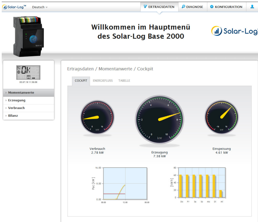
Abb.: Hauptmenü Solar-Log Base 2000
