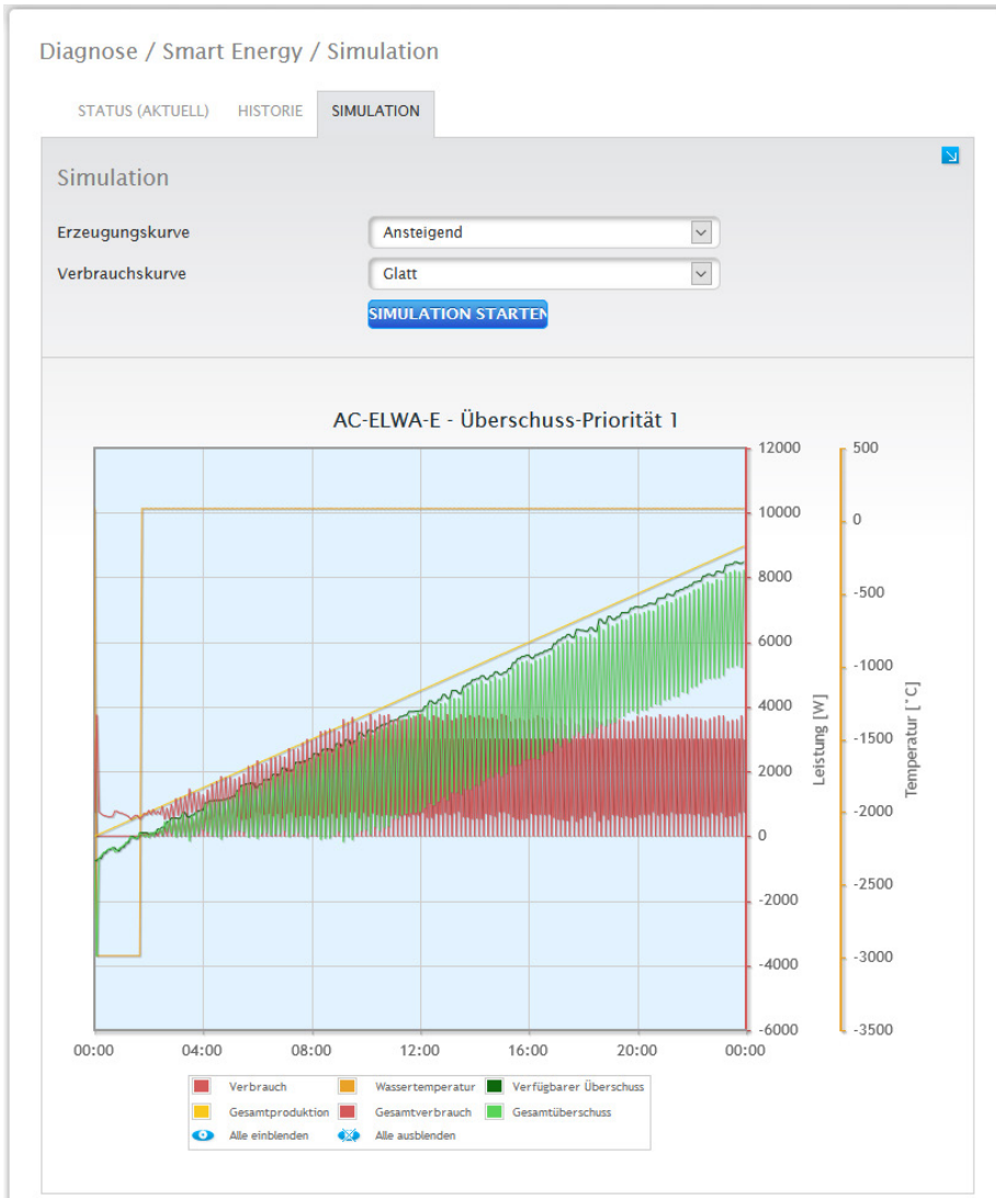
Abb.: Smart Energy - Simulation mit AC-ELWA-E - Überschuss-Priorität 1
