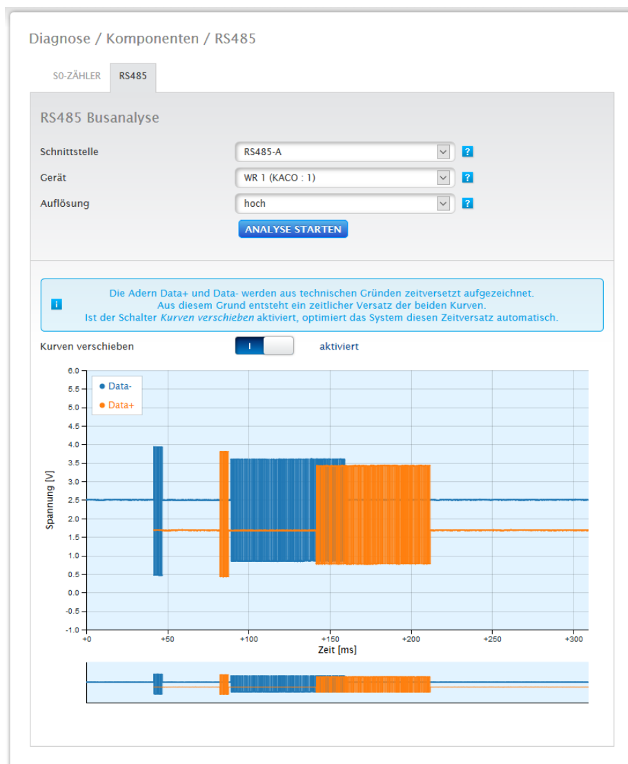
Abb.: Beispiel einer RS485-Busanalyse (bei aktiviertem Installationsmodus)
