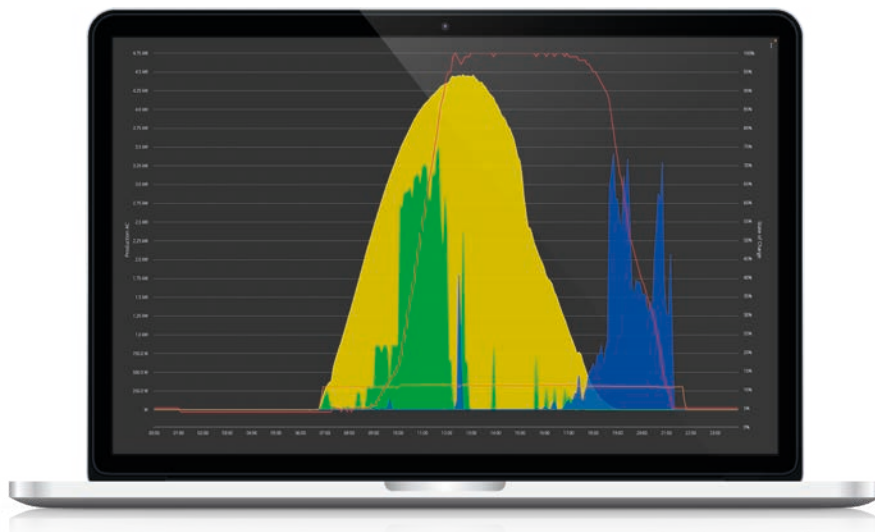
Tagesübersicht: Der Batteriespeicher wird mit der überschüssigen Leistung der PV Anlage geladen (violett) und bei Bedarf wieder entladen (hellblau), um den Bezug aus dem Netz zu vermeiden.
